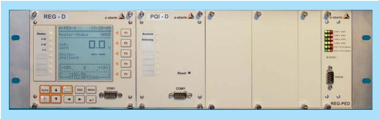
Bild 1: REGSys™ – Beispiel eines Mischsystems bestehend aus einem Spannungsregler REG-D™, einem Netzanalysator PQI-D mit Störschreiber und einer Protokollkarte REG-PED für die Anbindung via IEC 61850
