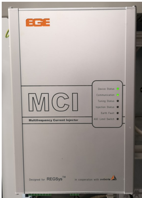
Abbildung 4: MCI verbunden mit REG-DP(A); "Device Status" und "Communication LED" leuchten grün
