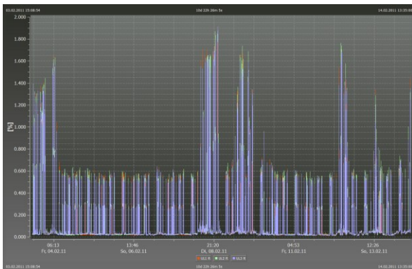
Nível de sinal de telecomando centralizado durante vários dias
