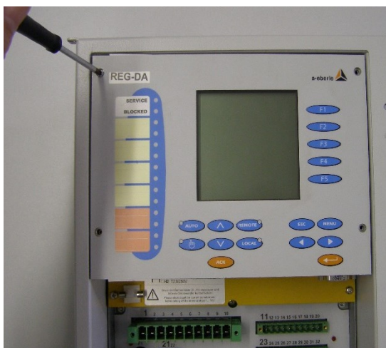
Отсоедините переднюю панель регулятора REG-DA
