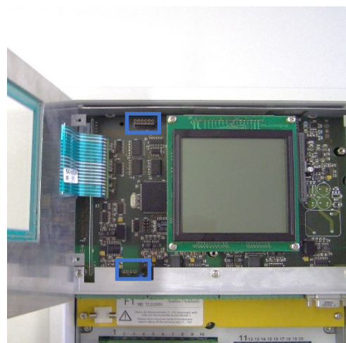
Откройте переднюю панель и найдите два соединителя (обозначенные оранжевыми прямоугольниками).
