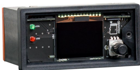
Abbildung 6: EOR-1DS mit abgeschraubter Frontplatte für Zugang zur SD-Karte
