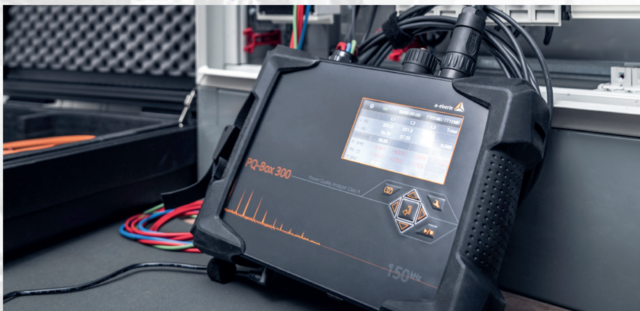
Figura 3: El analizador PQ-Box 300 en proceso de medición
