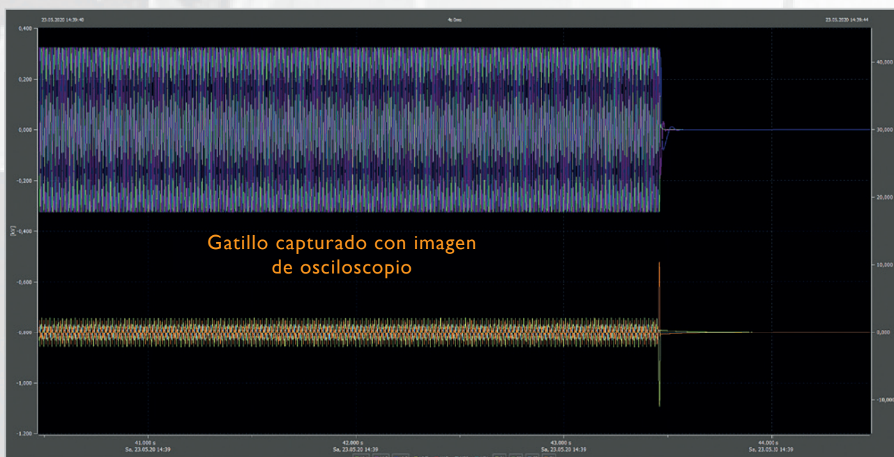
Figura 2: Imagen de osciloscopio de la tensión en L1, L2, L3 y de las corrientes de L1, L2, L3 y N durante 4000 ms de duración de la grabación con un largo historial y un incidente al final
