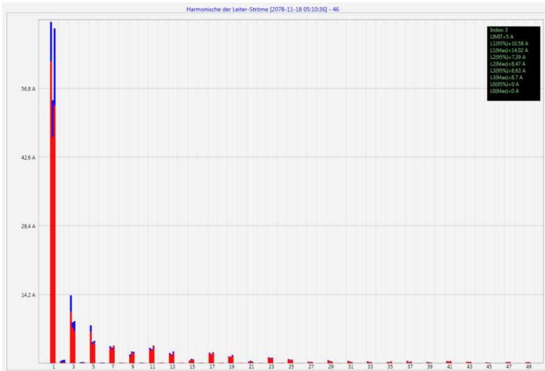
Statistik Stromharmonische 2 bis 50 – Skalierung in Ampere
