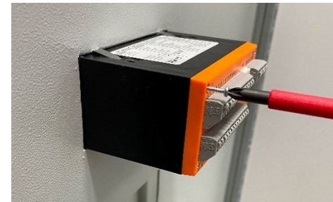
EOR-1DS im Schalttafel Ausschnitt noch ohne Halterahmen, ggf. mit bereits verdrahteten Einzeladaptern!
