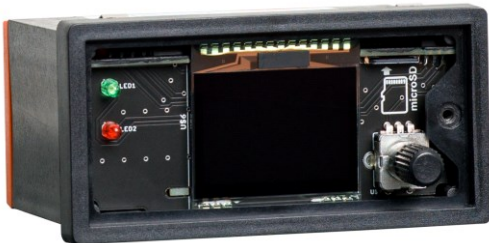
Bild 7: EOR-1DS mit abgeschraubter Frontplatte für Zugang zur SD-Karte
